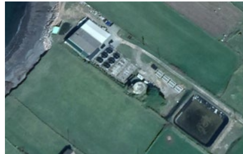
Figur 7. Tralee bay hatchery. På bilden ses det landbaserade kläckeriet, de 6 landbaserade trägen som används för algproduktion samt dammen som byggdes för produktion av O. edulis yngel. Bild från Google earth.
